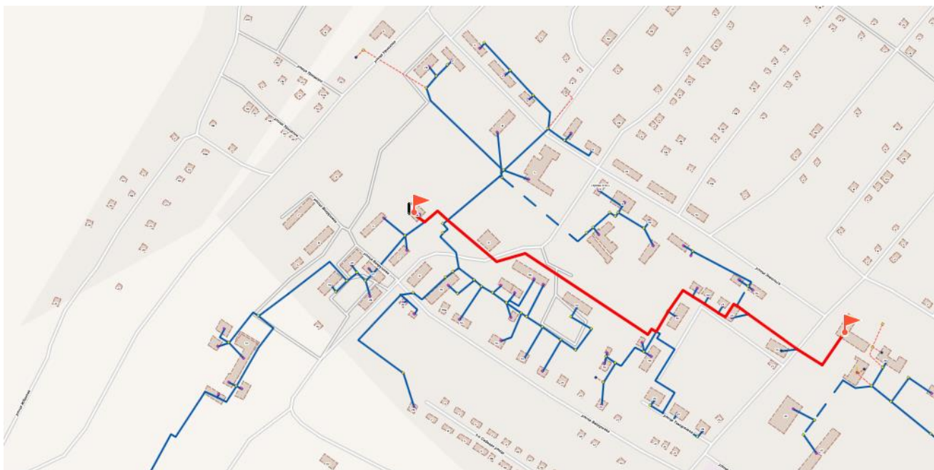
Рисунок 29 - Путь движения теплоносителя от котельной №8 ООО «Теплоэнергетик» до конечного потребителя
