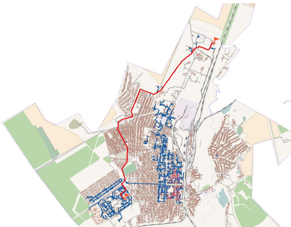
Рисунок 30 - Путь движения теплоносителя от котельной №10 ООО «Теплоэнергетик» до конечного потребителя
