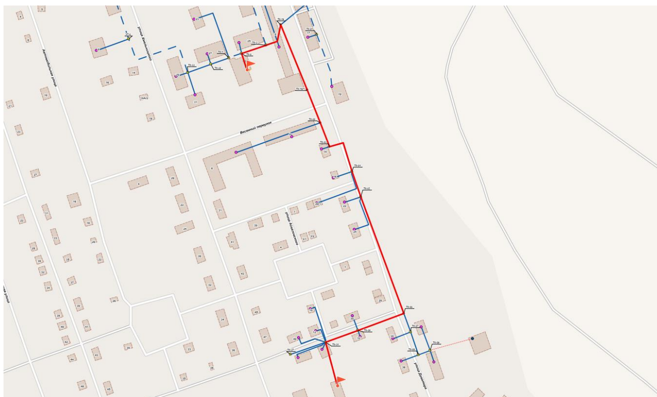
Рисунок 28 - Путь движения теплоносителя от котельной №6 ООО «Теплоэнергетик» до конечного потребителя
